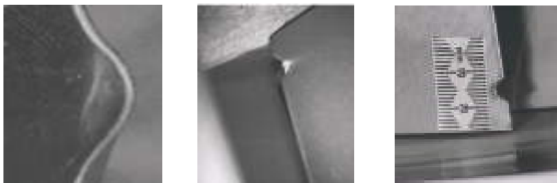
Рис. 1. Виды повреждений лопаток ГТД: вмятина, разрыв, забоина
